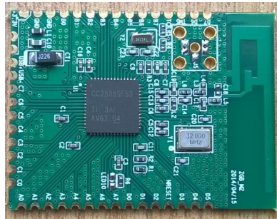
Figura 2.4 – Mote com o SoC T.I CC2538
