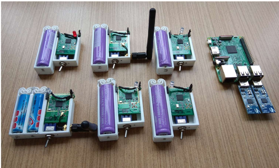
Figura 5.8 – Conjunto para testes em ambiente real da RSSF SD6WSN
