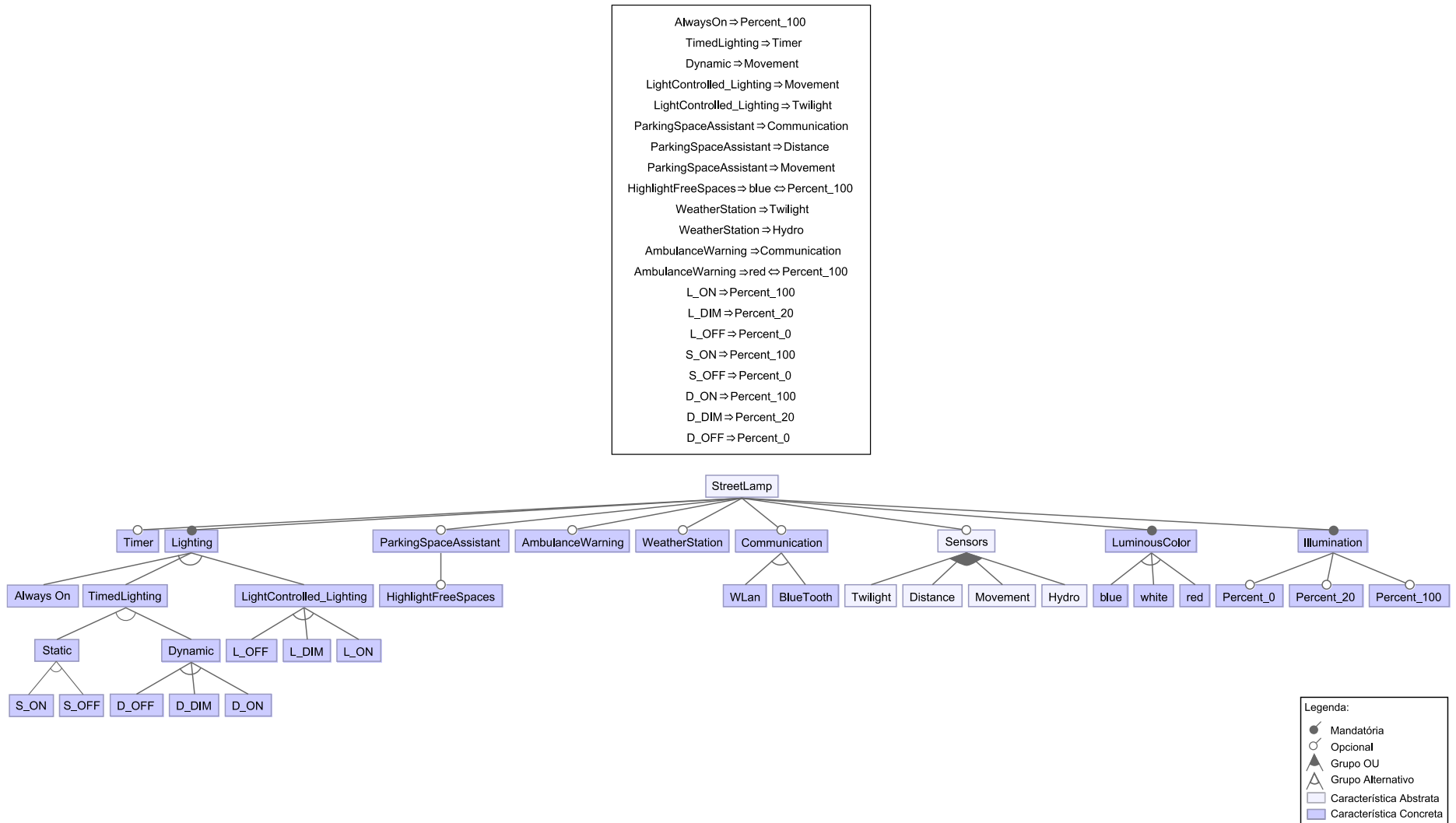
Figura 86. Feature Model da LPS Smart Street Light modelado na FeatureIDE. Adaptado da Figura 85.
