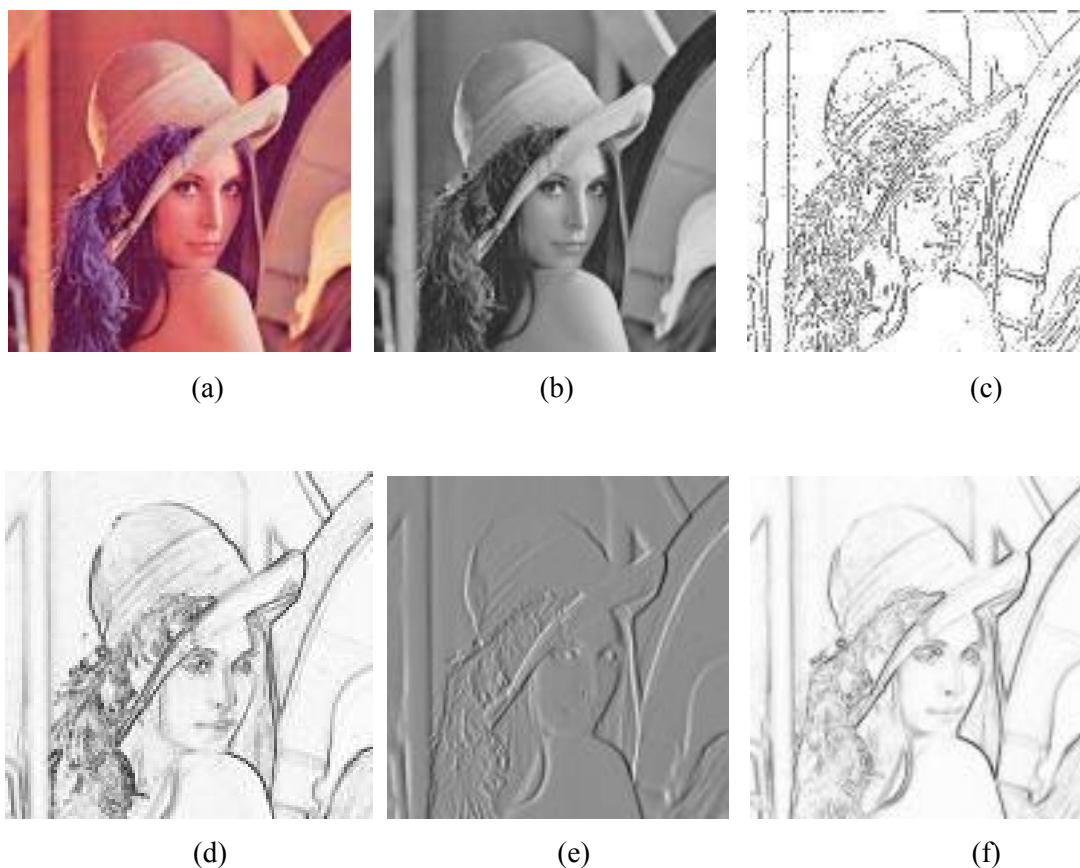
Figura 2.7 – Lenna: (a) imagem original; (b) imagem cinza; (c) Algoritmo Canny; (d) Algoritmo Prewitt; (e) Algoritmo Sobel G(y) ; (f) Algoritmo Sobel G=|G(x)|+|G(y)| .
