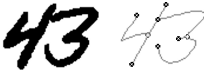
Figura 2.4: Imagem original à esquerda. À direita imagem esqueletizada com os respectivos pontos de característica do esqueleto (pontos finais e pontos de intersecção)
