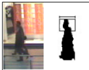
Figura 4.3: Exemplo de objeto onde a abordagem da Análise da Região Superior do Objeto falha contando uma pessoa ao invés de duas.
