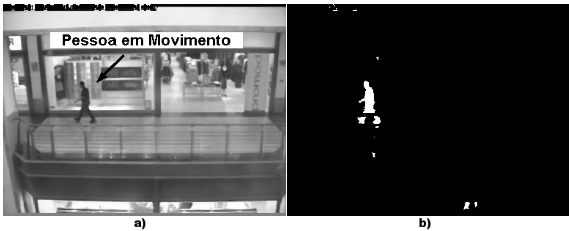
Figura 3.3: a)quadro de entrada em níveis de cinza. b)resultado da subtração do fundo
