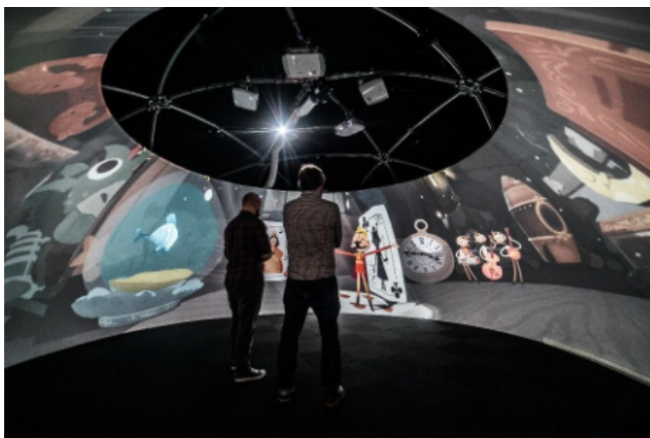
Figura 16 – Modelo de CAVE no formato domo produzida pela empresa Igloo Vision.
