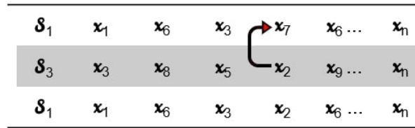
Figura 18 – Mutação, onde S_1 e S_3 representam os subproblemas, x_7 representa a instância que foi substituída por x_2 .
