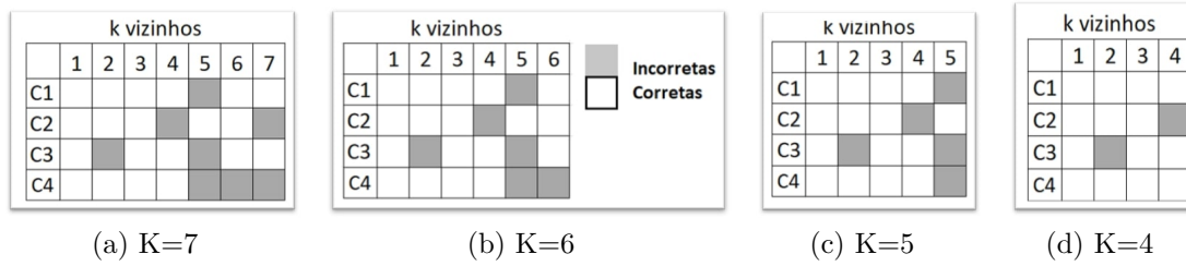
Figura 7 – Representação do algoritmo KNORA-E para 4 classificadores e k = 7 em (a), 6 em (b), 5 em (c) e 4 em (d).
