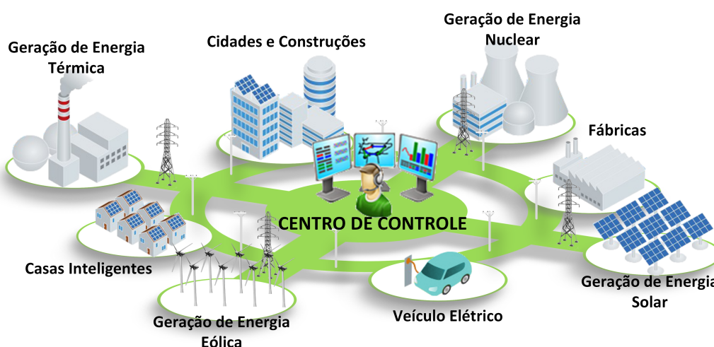
Figura 1.1: Arquitetura típica Smart Grid
