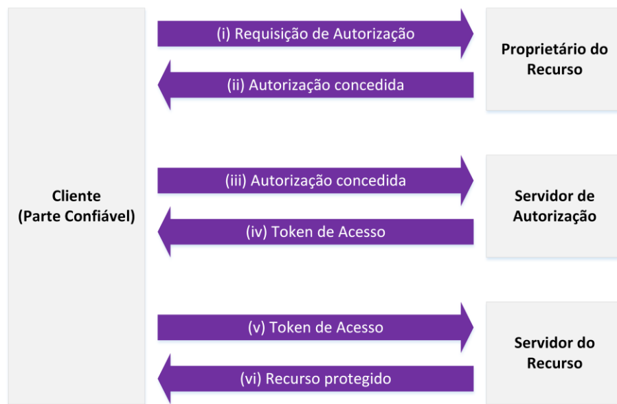
Figura 2.4. Fluxo do protocolo OAuth. Adaptado de (HARDT, 2012).
