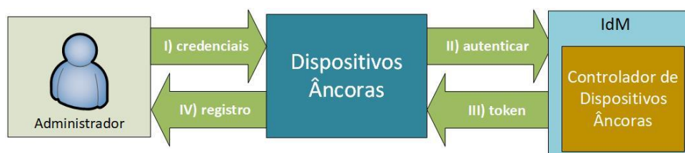
Figura 13 - Módulo de controle de dispositivos âncoras.
