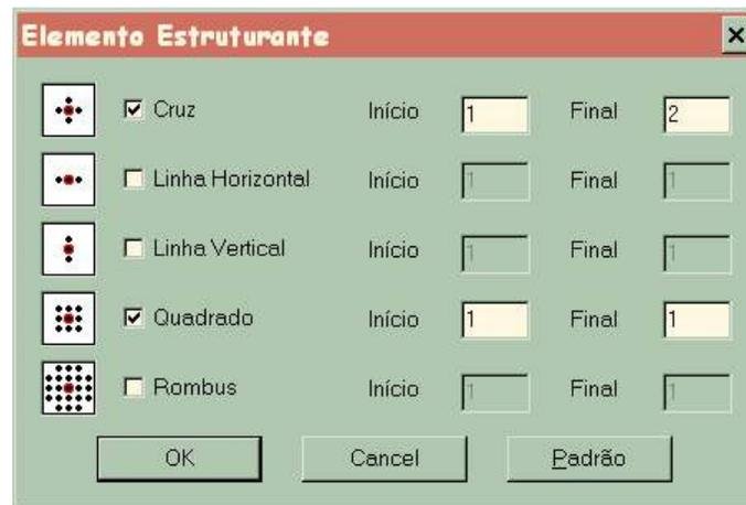
Figura 6.7 Configuração dos parâmetros da morfologia matemática binária utilizados para elementos estruturantes e número de iterações
