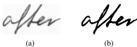
Figura 4.2: Exemplo da aplicação do algoritmo de Otsu para limiarização de imagens em nível de cinza, sendo que a Figura 4.2(b) é o resultado da aplicação deste método na Figura 4.2(a).
