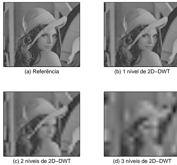
Figura 37: Três níveis de 2D-DWT aplicados à imagem Lena monocromática de tamanho 128 \times 128 pixels. (a) Imagem de referência. (b) 1 nível de 2D-DWT. (c) 2 níveis de 2D-DWT. (d) 3 níveis de 2D-DWT.
