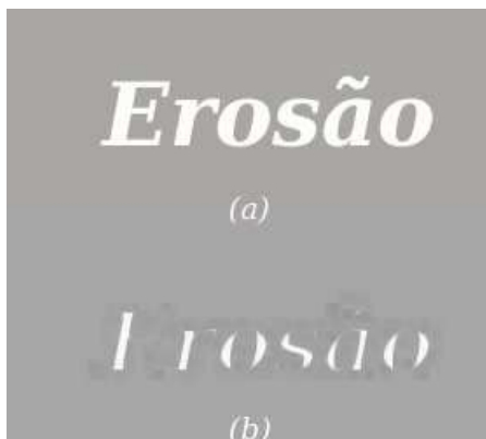
Figura 2.13: Erosão em níveis de cinza com elemento estruturante quadrado planar e duas iterações: (a) Imagem original, (b) Imagem erodida.
