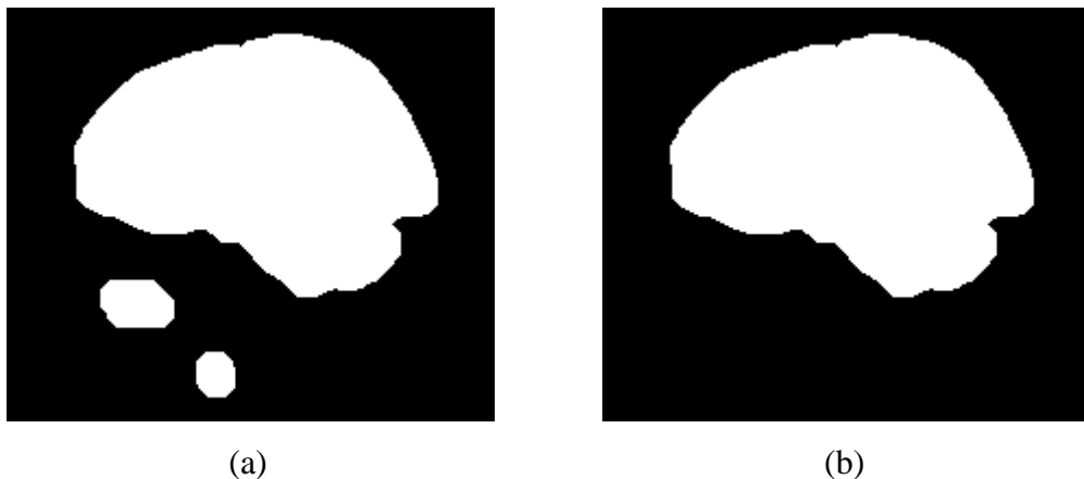
Figura 3.24: a) Imagem antes do processo de eliminação das menores áreas. b) Imagem após a limpeza.
