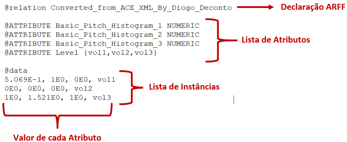
Figura 10 – Exemplo da estrutura de um arquivo no formato ARFF.
