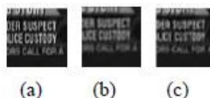
Figura 2.16 – (a) Imagem níveis de cinza, (b) imagem filtrada pela média e (c) imagem filtrada pela mediana.
