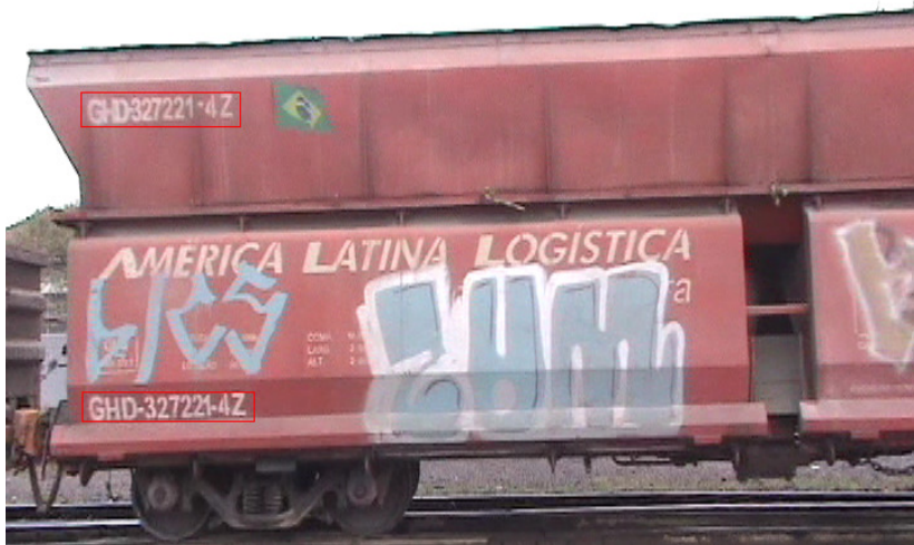
Figura 3.20 – Imagem com os candidatos a código de identificação dos vagões referente à primeira abordagem adotada na etapa de Segmentação.
