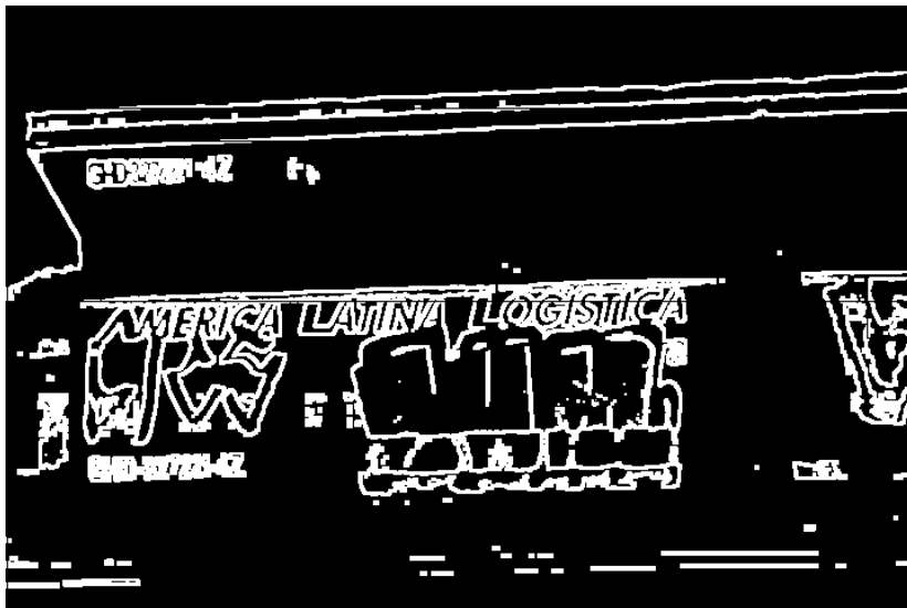
Figura 3.6 – Imagem após a operação morfológica de dilatação em uma imagem filtrada anteriormente por Laplaciano.
