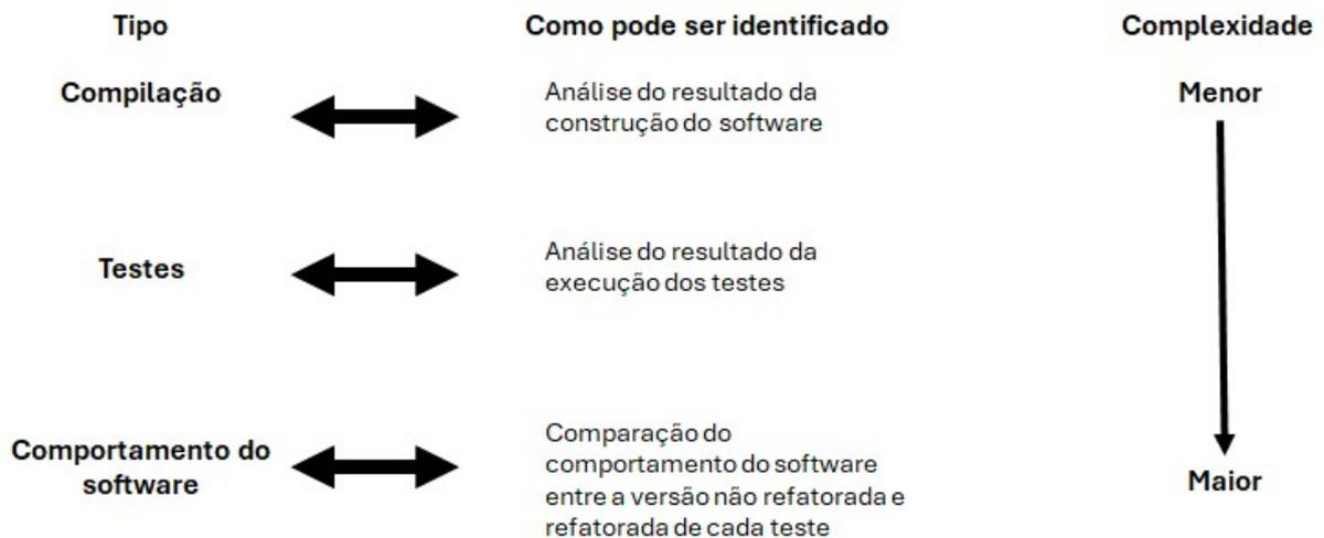
Figura 4-2 Tipos de erros causados pela refatoração automática e como podem ser identificados (Fonte: o autor)
