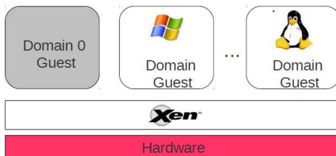
Figura 2.6 – Módulos que compõem o Xen. Adaptada de anônimo.
