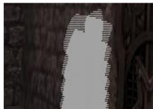
Figura 57 – Anomalia de renderização na *Irrlicht* causada pelo "empilhamento" de geometrias planas.
