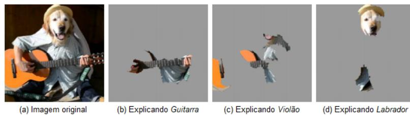
Figura 2.7: Saída obtida pelo LIME em um algoritmo que classificou a imagem como Labrador (21%), Violão (24%) e Guitarra (32%).
