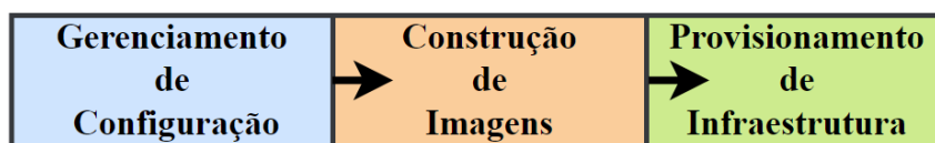
Figura 2 – Categorias da IaC: Gerenciamento de Configuração (Ansible, Chef, Puppet), Construção de Imagens (Packer, Docker) e Provisionamento de Infraestrutura (Terraform, TOSCA, Cloudify)
